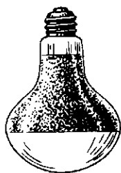
Рис. 1-1. Прожекторная лампа типа ПЖ-220-1000-2
